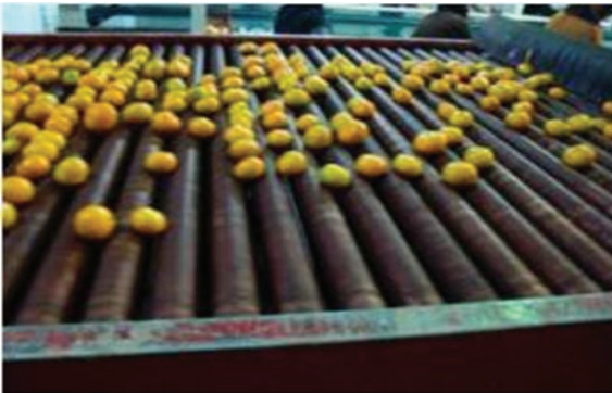
شکل ۳-۵۶- صاف و یکنواختی کف نقاله و عاری بودن از لبه های تیز ایجادکننده زخم
